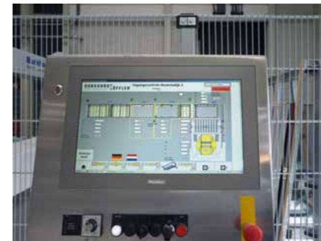
Leichte Eingangskontrolle dank Software: Auf dem Monitor sind die einzelnen (bereits von der Software eingepflegten) Platten auf einer schematischen Darstellung der Anlage identifizierbar
