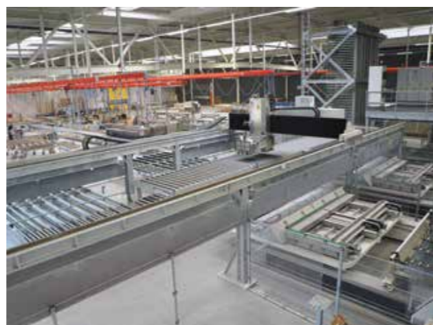
Im vollautomatischen Speicherregal (hinten rechts) zwischengelagerte Werkstücke werden auf der oberen Ebene einer doppelstöckigen Rollenbahn den beiden CNC-Bearbeitungszentren zugeführt
