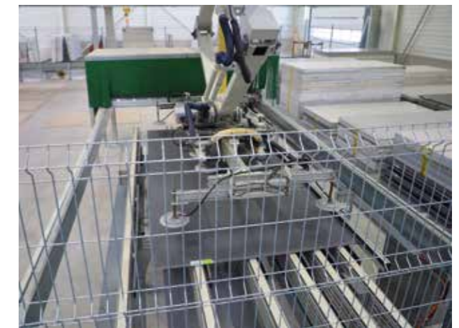
Mit einem Vakuumflifter werden die Platten aus dem Flächenlager auf einer Riemenförderstrecke mit Zentrierung und pneumatischen Aushüben abgelegt, jedes Werkstück bekommt einen Barcode
